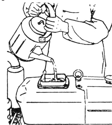
Fig. 6 Colocar água limpa no radiador
