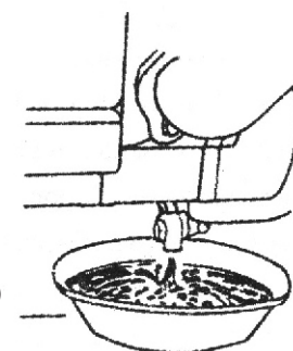
Fig. 9 - Drenando a água de resfriamento.
